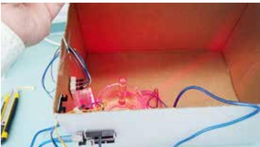
圖 9.3 利用微控制器控制光照時間，探究光色與氧氣生成
